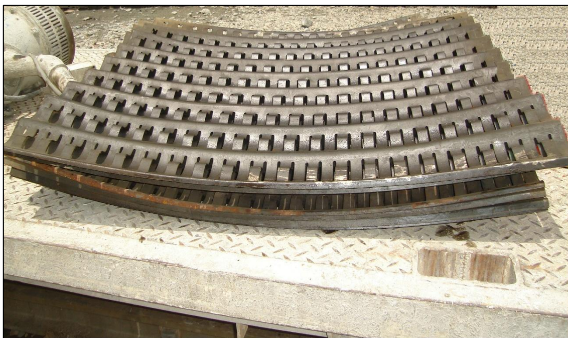
FOTO 3 : PLANCHA BERNOLD CURVADA SEGÚN EL RADIO DEL TUNEL
